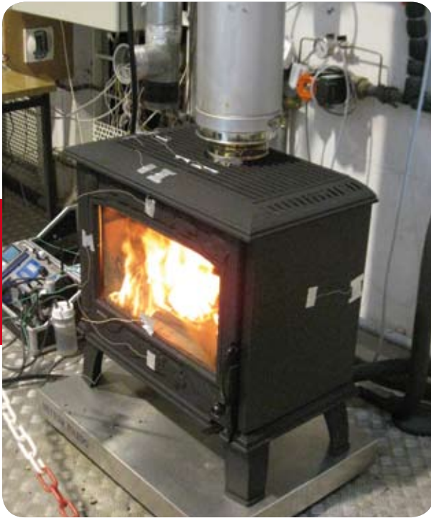
Essais de rendement de poêles à bois
