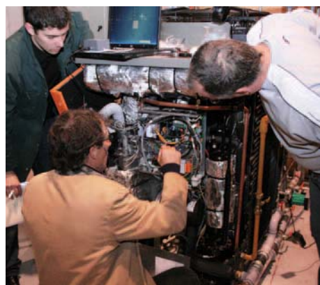
Le COSTIC étudie notamment le dimensionnement, l'installation, la maintenance et l'exploitation des pompes à chaleur gaz à absorption.
